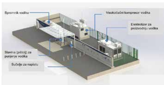
Slika 5. Postrojenje za proizvodnju i skladištenje vodika i punionica vodika
